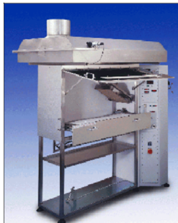
Bild 3: Flooring Radiant Panel Test nach EN ISO 9239-1
