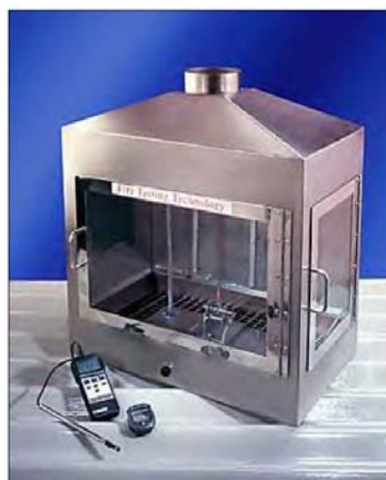
Bild 2: Kleinbrenner nach EN-ISO 11925-1 Foto: BASF AG
